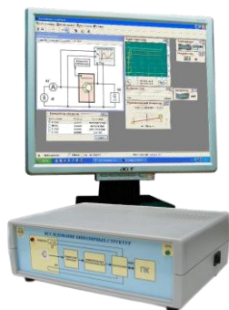
Рисунок 1. Автоматизированный лабораторный стенд для исследования биполярных структур
